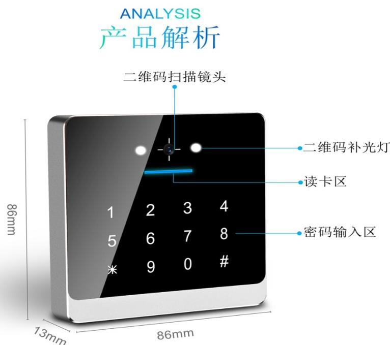
感应卡：把感应卡放在刷卡区域，蜂鸣器鸣响及读卡区域图标变绿色，读卡成功并输出数据；
